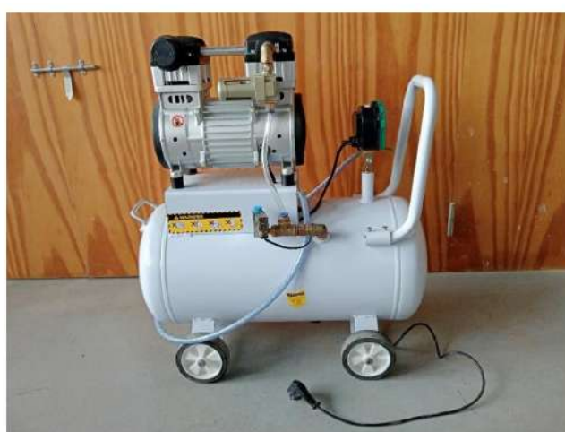
Bomba de vacío
